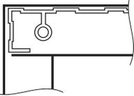
▲の方向からボルト及び、ばね座金で止める
