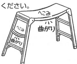
④各部の接合部に割れやいちじるしい腐食がありませんか。また、取り付け部品の破損・脱落・変形・磨耗・いちじるしい腐食がありませんか。ある場合は、絶対に使わないので廃棄してください。
