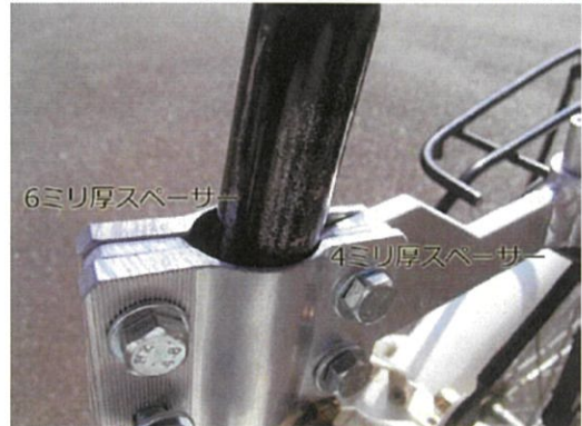
【サドルポストの直径が 28.2mm~29mm の場合】
