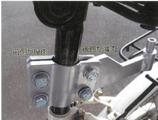
【サドルポストの直径が 25.2mm~26mm の場合】
