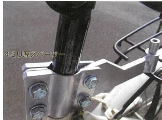
【サドルポストの直径が 26.2mm~27mm の場合】
