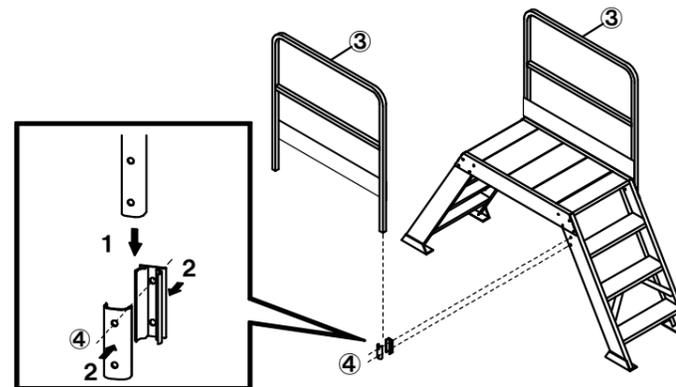
【3】 【1】【2】で組立たものに階段部の手すりを図のように確実に固定してください。つぎ手の各部が正しい位置に納まっているか確認した後、順次ボルト・ナットが確実に締付けられているか確認してください。
