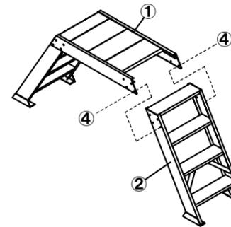
【2】 次に手すりユニットの天場部分を【1】で組立たものに図のように確実に固定してください。
