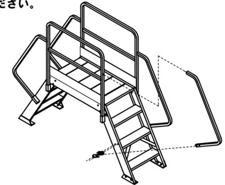
【4】 アンカーを地面に打ち込み、四脚とも確実に固定してください。
