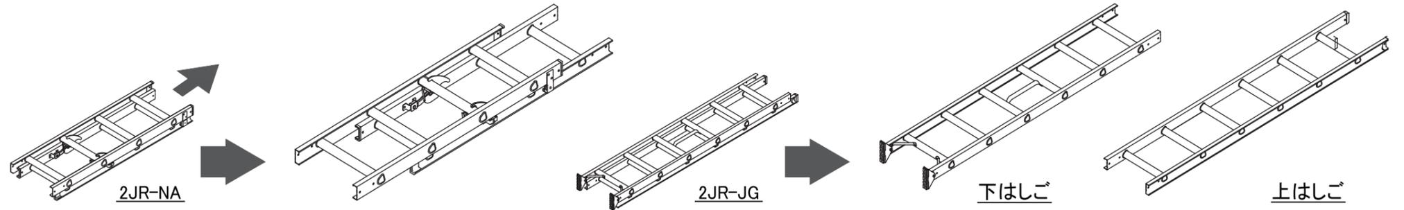
② 中はしごユニットを上はしごと水平になるように置き、支柱を連結板(小)(大)で図1のようにはさみこむようにし、低頭ボルト・ゆるみ止めナットにて仮止めしてください(片側4本)。 ※組付の際、図2のように踏ざんが同じ向きになるように注意して組み立ててください。
