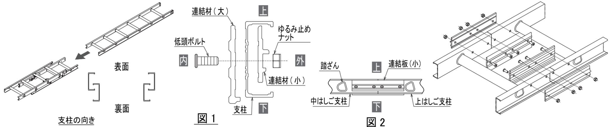
③ 連結板(大)(小)が正しい位置に組み立てられているかを確認後、順次低頭ボルトを確実に締め付けてください。
