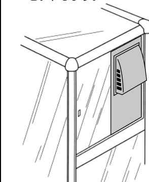
4 換気扇の電源プラグを換気扇用電子温度調節器のコンセントに差し込みます。
