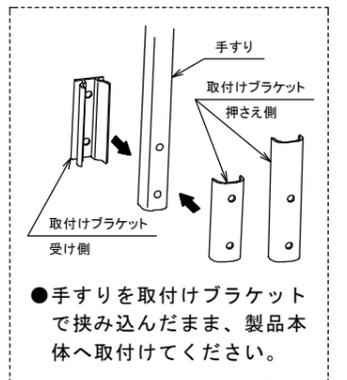
●手すりを取付けブラケットで挟み込んだまま、製品本体へ取付けてください。
