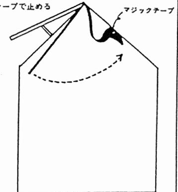
※天窓を開けた時には、予備のマジックテープを使って、フタを天窓と反対側の屋根面に取り付けて下さい。
